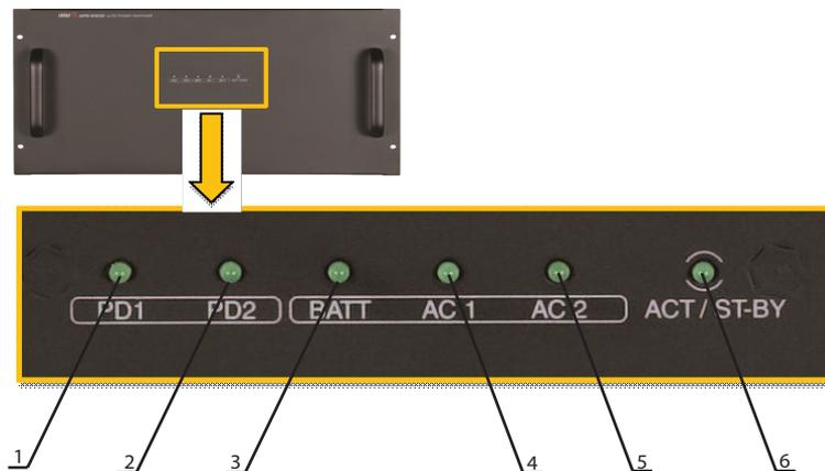
**1. Индикатор работоспособности блока контроля и распределения питания №1**
